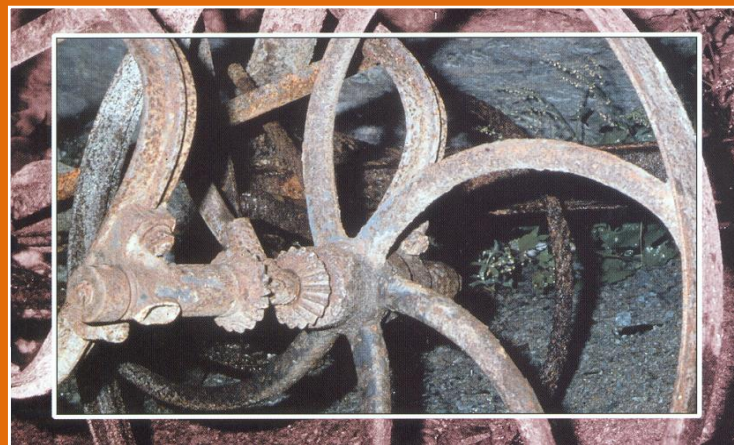
Ventilateur manuel utilisé vers 1900 Handbetriebener Ventilator um 1900
